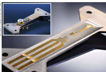
Bild 4: Additiv hergestellter DMS auf einem Stahlbauteil. Das Bild darüber zeigt das Stahlbauteil mit integrierter Telemetrie.
